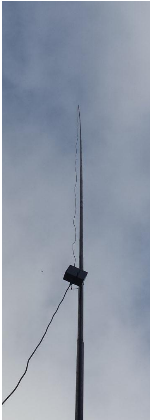
Een op het einde gevoede halve golf monopool.
